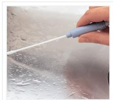
*Reagentes próprios evitam interferência química e permitem testes ATP, antes ou depois da higienização.*
